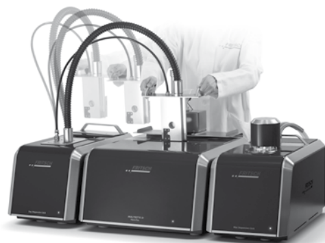
Le module de dispersion adapté à toute situation : pour modifier la dispersion, échangez tout simplement la cellule de mesure
